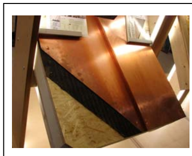
発泡系断熱材で造られた屋根模型
